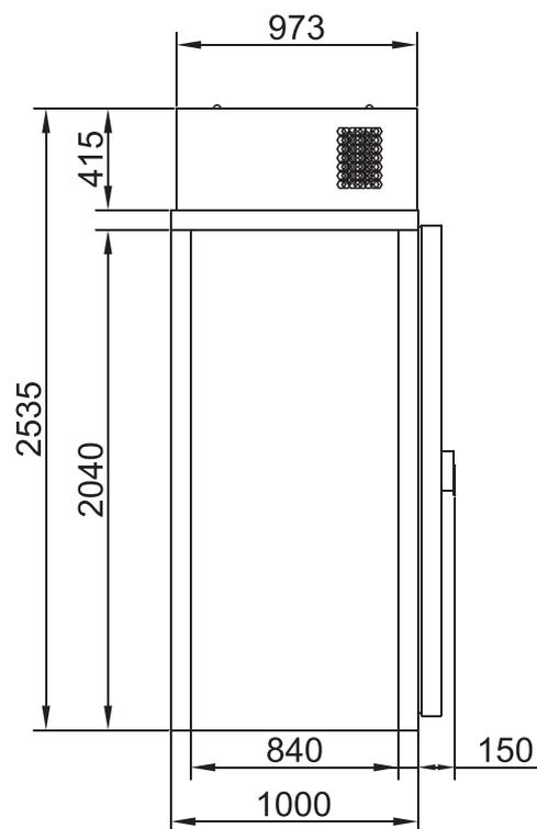
4. Камеры без пола с двумя дверными блоком. Выполняются в среднетемпературном режиме.
