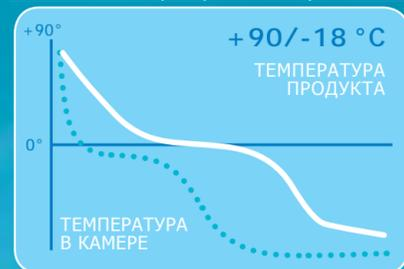
Здесь обеспечивается более однородное замораживание, и поэтому этот цикл подходит для пищи, которая не должна иметь резких перепадов температур или пищи из различных ингредиентов. Время выхода на температуру -18 °С составляет примерно 270 минут.
