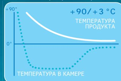
«Жесткий» цикл отличается малым временем шокового охлаждения и идеален для продуктов высокой плотности или с высоким содержанием жира, а также упакованной пищи.
