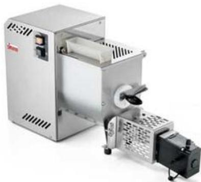
НАСАДКА PASTACUTTER ПРЕДНАЗНАЧЕНА ДЛЯ ОБРЕЗКИ КОРОТКИХ МАКАРОН.
