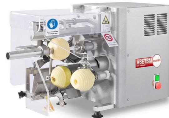
Машина для обработки яблок - очистка, удаление сердцевины, разделение, нарезка ломтиками и мелкими кусочками 70 - 100 кг /час
