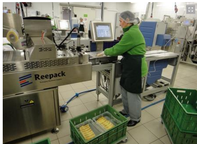
Рис. 2 Процесс упаковки продукции в индивидуальные барьерные лотки:
