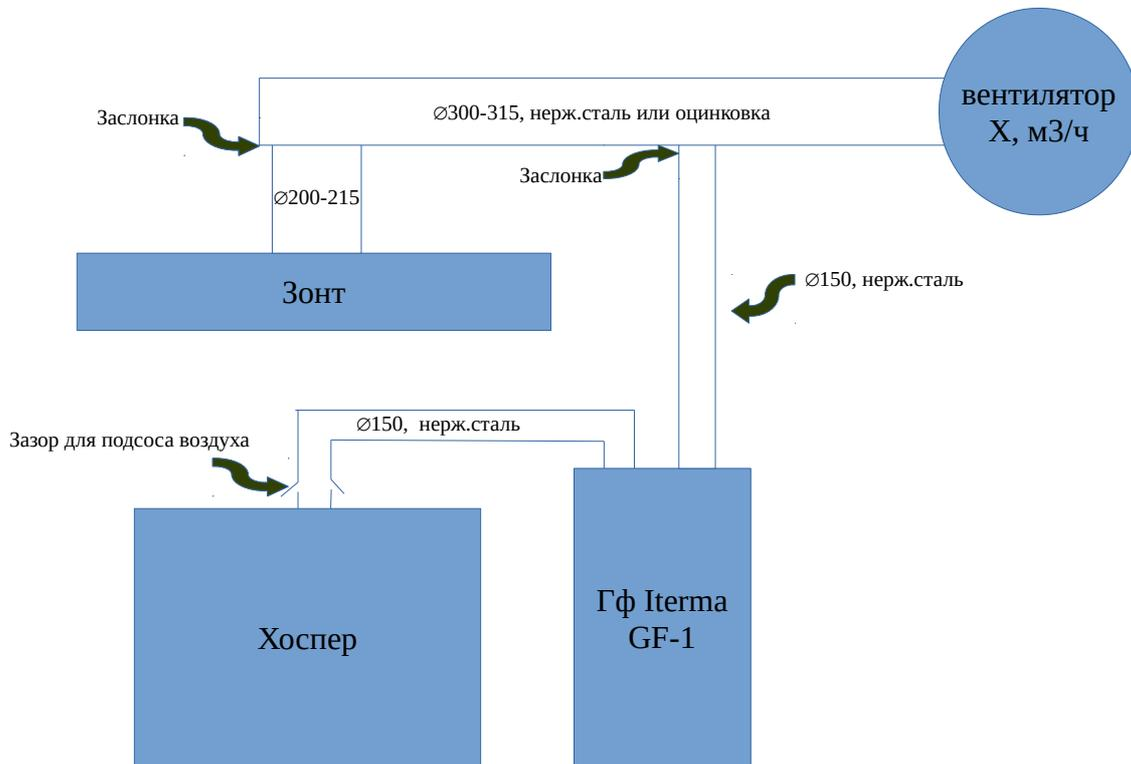
где  $X$ -производительность вентилятора, которая должна соответствовать требуемой производительности вентиляции для конкретной модели хоспера и учитывать потери в воздуховодах (при расчете аэродинамическое сопротивление гф принимать равным нулю). Штатный мотор гф Iterma при данном способе не устанавливается.
