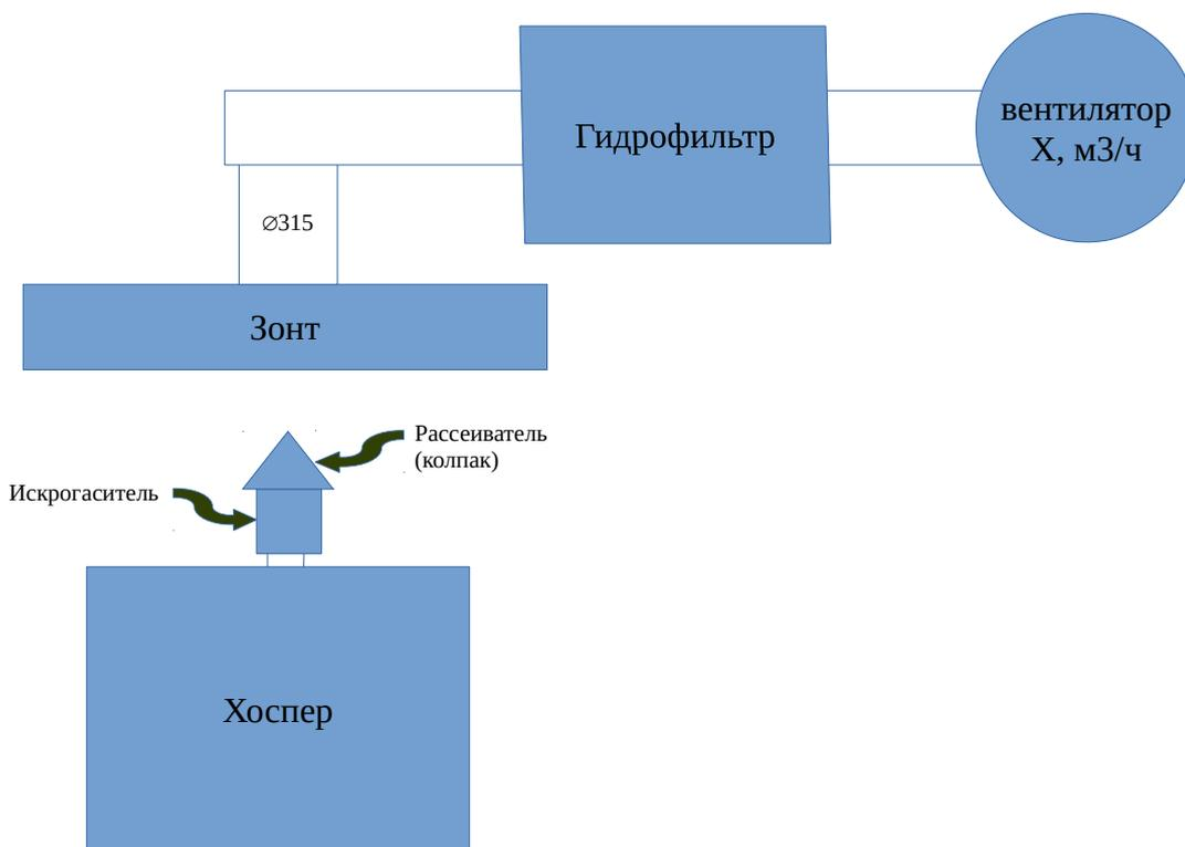
где  $X$ -производительность вентилятора, которая должна соответствовать требуемой производительности вентиляции для конкретной модели хоспера и учитывать потери в воздуховодах (при расчете аэродинамическое сопротивление  $z_f$  принимать равным нулю).
