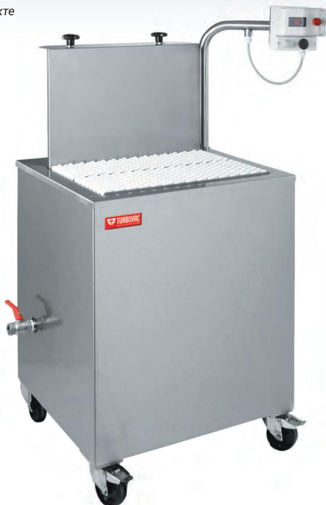
Термоусадочные водяные tanks Turbovac применяются для усадки вакуумной упаковки относительно продукта. Под воздействием воды высокой температуры пленка становится эластичной, разглаживаются складки, значительно уменьшаются торчащие углы пакета. Визуально кажется, что продукт обтянут «второй кожей». Чаще всего такая упаковка применяется для мясных, колбасных изделий: ветчины, окорока, тушки птицы и др.
