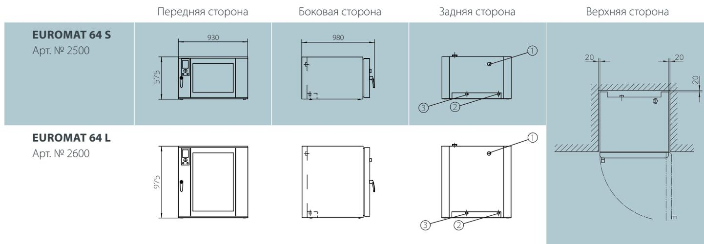
1 Воздухоотвод 50 мм 2 Электроподключение 3 Подвод воды 3/4"
