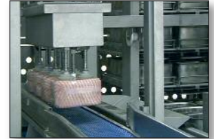
3/ Automatisches Entformen Автоматическое извлечение из форм
