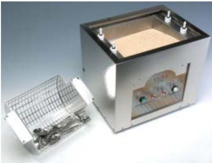
... caricare circa 60 posate nel cesto, appoggiarlo sul granulare vibrante e spingerlo delicatamente dentro alla vasca fino a far entrare i fori delle maniglie sui pioli di sostegno...
