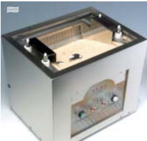
...il ciclo di asciugatura dura 2 minuti ma la vibrazione si ferma dopo 3 minuti per permettere, in questo lasso di tempo, l'immersione e l'estrazione del cestello che deve essere fatta solo durante la vibrazione (ripremere il pulsante bianco se la vibrazione si fosse fermata)...
